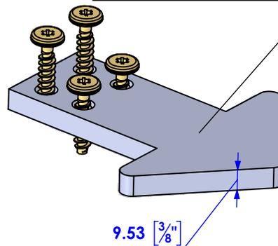
Unión de reductor sin anclas mediante placas de acero en forma de flechas de 9.53 mm (3/8") y 4 pijas.
