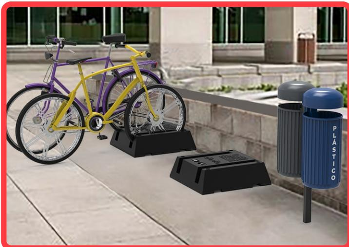
Marcamos los 4 barrenos de cada base y con ayuda de un taladro con broca de  $\frac{3}{4}$ " para concreto, proseguimos a perforar el área asignada a una profundidad de 7", introduzca los taquetes en los barrenos, coloque el biciestacionamiento, inserte los tornillos y rondanas planas de  $\frac{3}{8}$ ", con un dado  $\frac{9}{16}$ " apriete los 4 tornillos perfectamente; su instalación esta lista.
