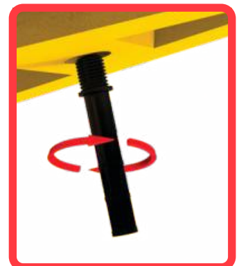
Colocación de pernos
