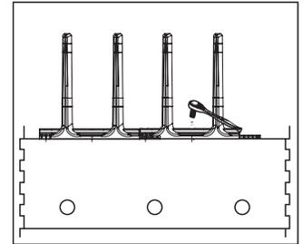
Coloque la paleta en posición, haga el disparo con el perno de 1/4", en cada 1 de los 3 barrenos, use la paleta como guía; coloque su rondana y tuerca.
