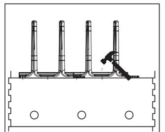
Marque sus barrenos usando la paleta como guía, perforo con broca de 1/4", coloque los taquetes. Con la ayuda del martillo de unos golpes para que entre bien el perno.
